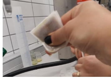
Şekil 3.19. Torbalar elle hafifçe sıkılması
