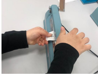
Şekil 3.17. Torbaların ağız kısımlarının mühürlenmesi
