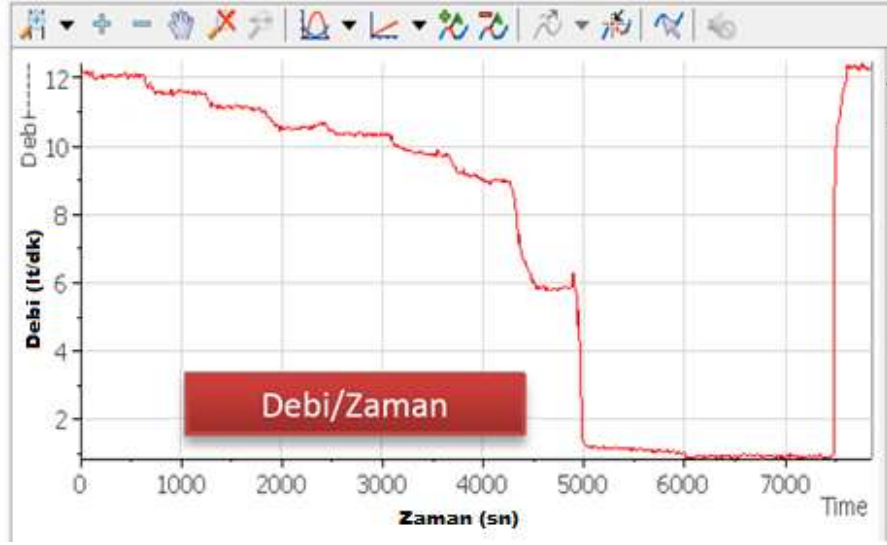
Şekil 5. 8 Uzun süreli test debi(lt/dak) zaman(sn) grafiği (4Nolu pompa)
