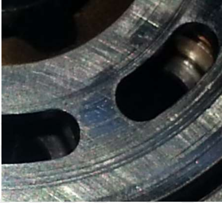
Şekil 5. 23 15 saat çalışmış 3 nolu pompa silindir blok yüzeyi
