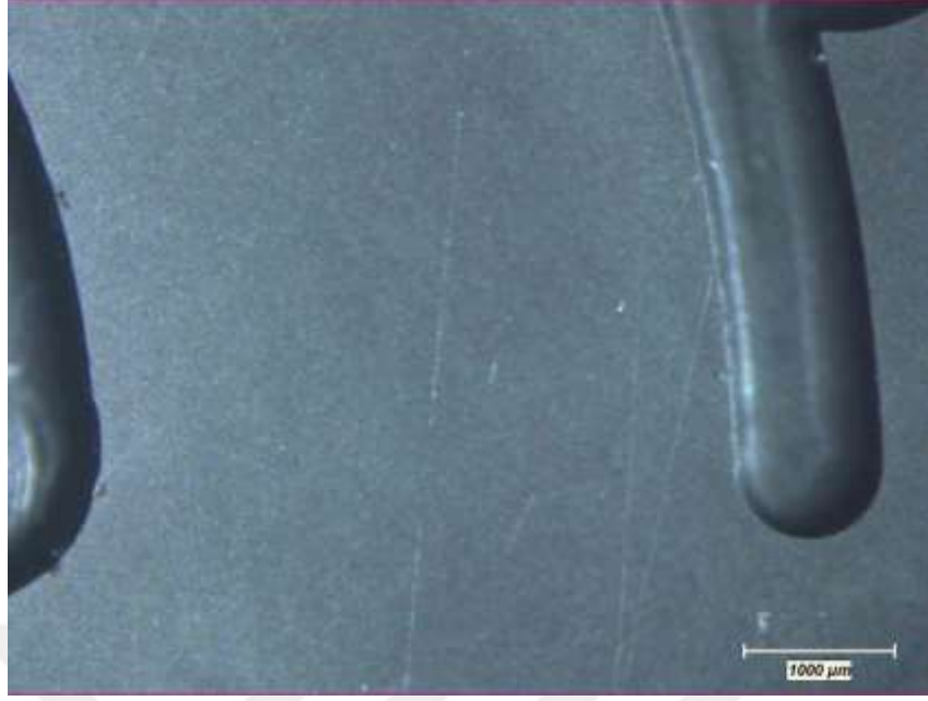
Şekil 4. 9 1 nolu piston pompa kapak test öncesi yüzey mikroskop görüntüsü
