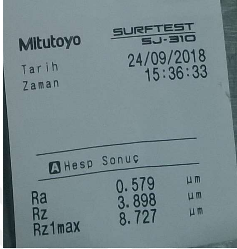
EK-13 15 saat çalışmış 4 nolu pompa silindir blok yüzey pürüzlülüğü
