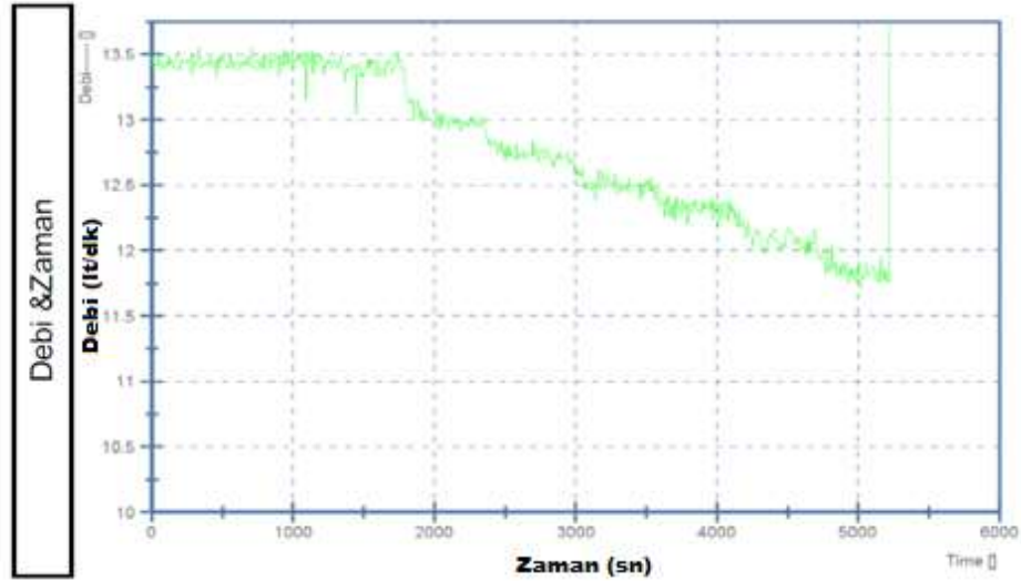
Şekil 5. 5 Uzun süreli test debi(lt/dak) zaman(sn) grafiği
