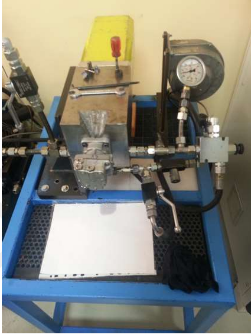
Şekil 3. 11 Piston pompanın montajı ve yüksek devirli motor
