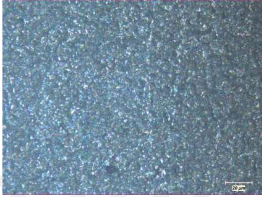
Şekil 4. 11 1 nolu piston pompa kapak test öncesi yüzey mikroskop görüntüsü
