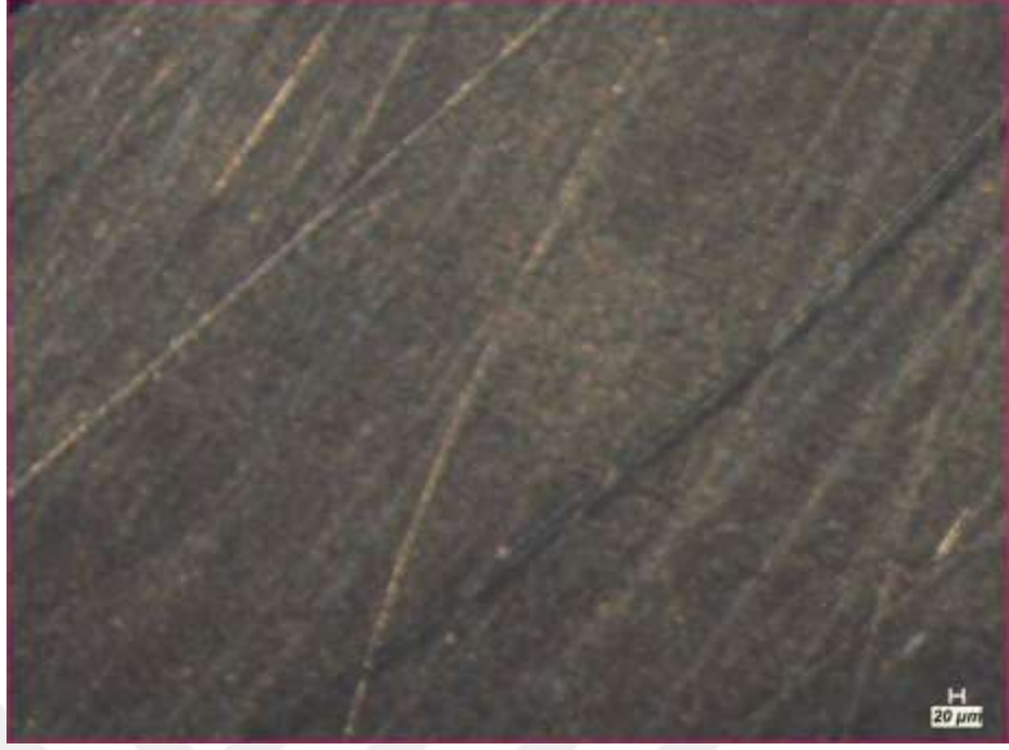
Şekil 5.13 5 saat çalışmış 4 nolu pompa kapak yüzeyi
