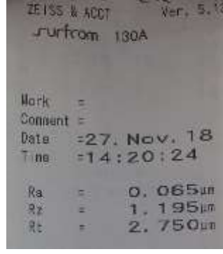
EK-18 5 saat çalışmış 3 nolu pompa arka kapak yüzey pürüzlülüğü
