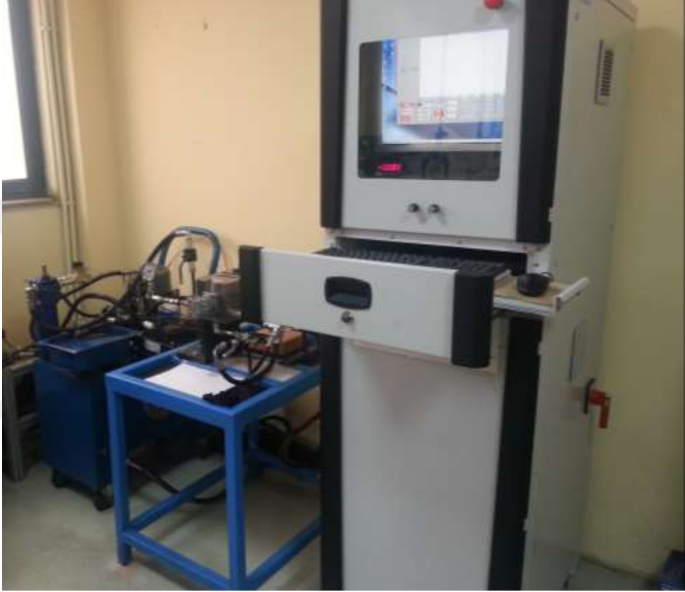
Şekil 3. 8 Yüksek devir piston pompa test tezgâhı
