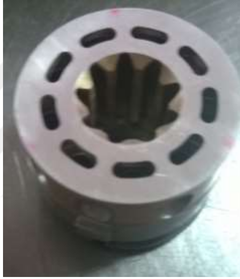
Şekil 3. 6 Piston pompa silindir bloğu aşınma temas yüzeyi
