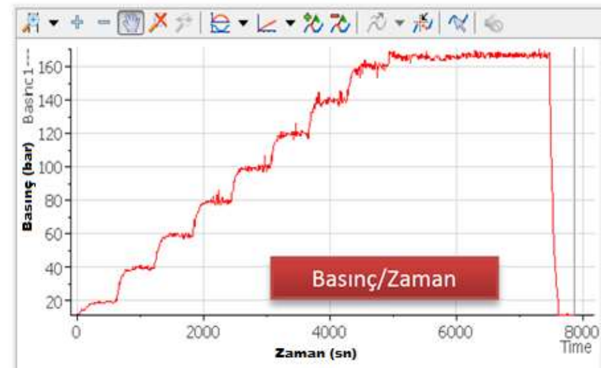
Şekil 5. 7 Uzun süreli test basınç(bar) zaman(sn) grafiği (4Nolu pompa)
