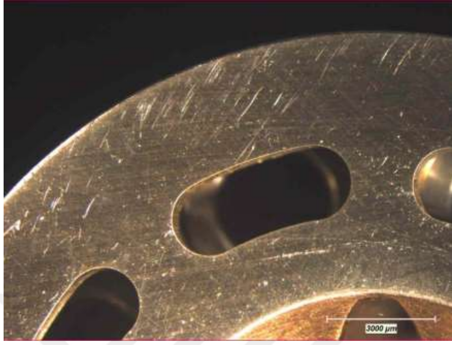
Şekil 4. 5 2 nolu piston pompanın test öncesi yüzey mikroskop görüntüsü
