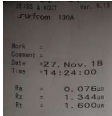
EK-20 5 saat çalışmış 4 nolu pompa arka kapak yüzey pürüzlülüğü
