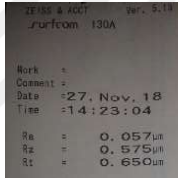
EK-16 5 saat çalışmış 2 nolu pompa arka kapak yüzey pürüzlülüğü
