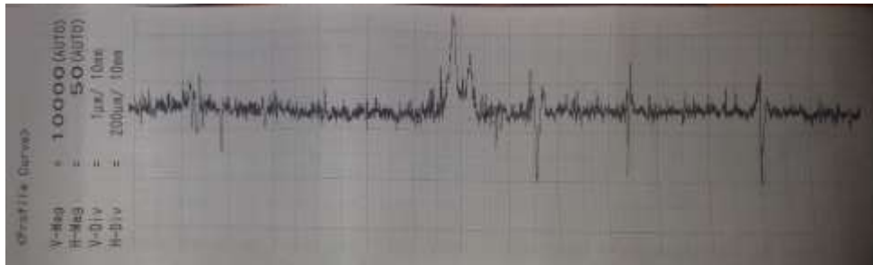
EK-23 10 saat çalışmış 1 nolu pompa arka kapak profil eğrisi
