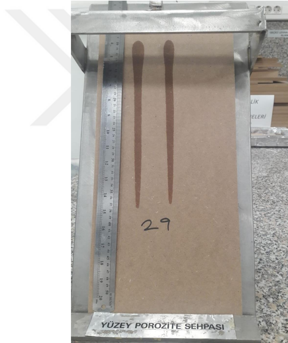
Şekil 3. 3. Porozite ölçüm sehпасı ve ölçüm yapılmış test levhası.
