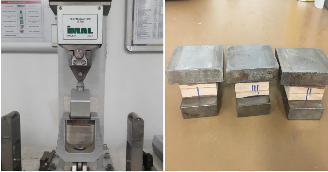
Şekil 3. 5 Çekme Direnci testinin yapılması ve kopan levha örnekleri.
