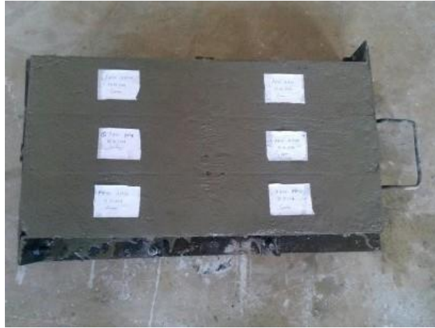
Şekil 2.5.4. Taze betonun kalıplara yerleştirilmesi
