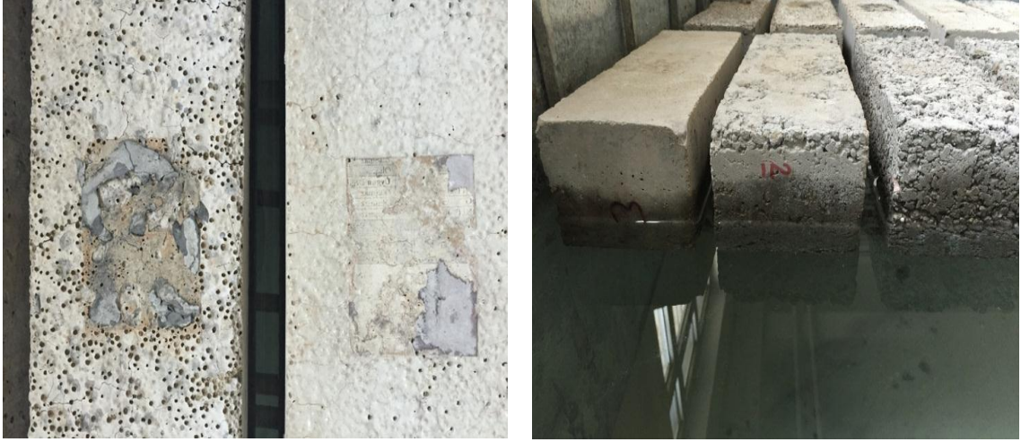
Şekil 2.7. Yüksek sıcaklık sonrası numunelere su emdirilme
