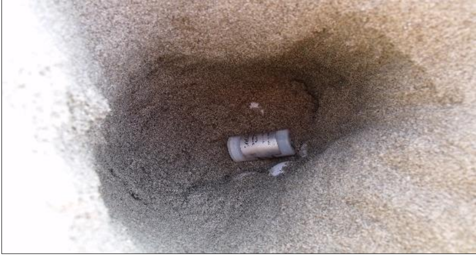
Şekil 3.5. Yuva içerisine sıcaklık ölçer yerleştirme
