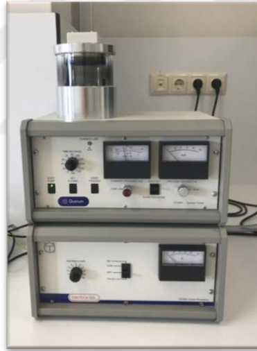
Şekil 3.18. Vakum altında örneklerin altın/palladyum ile kaplanması
