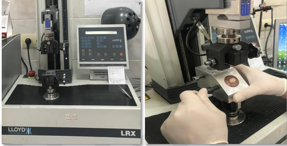
Şekil 3.16. Universal test cihazı ve örneğin yerleştirilmesi
