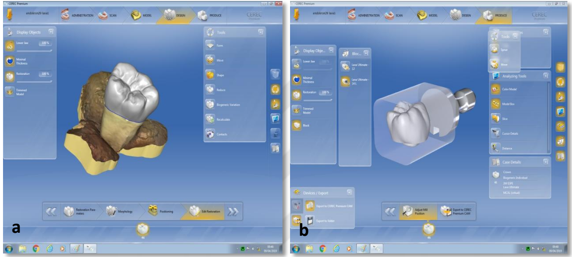
Şekil 3.12. a) Üretim aşamasına geçilmeden önce restorasyonun kontrol edilmesi, b) Tasarlanan restorasyonun ve tijin sanal blok içerisinde kontrol edilmesi
