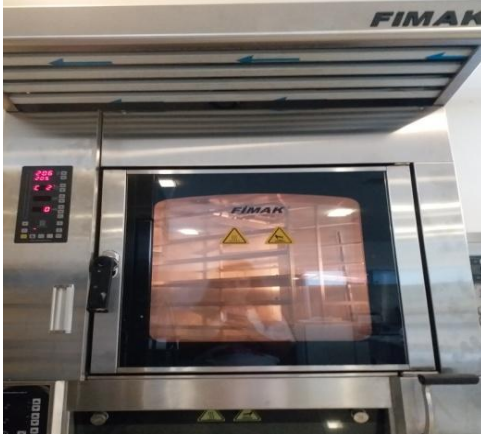
Şekil 3.2. Biskivinin pişirildiği konveksiyonel fırın
