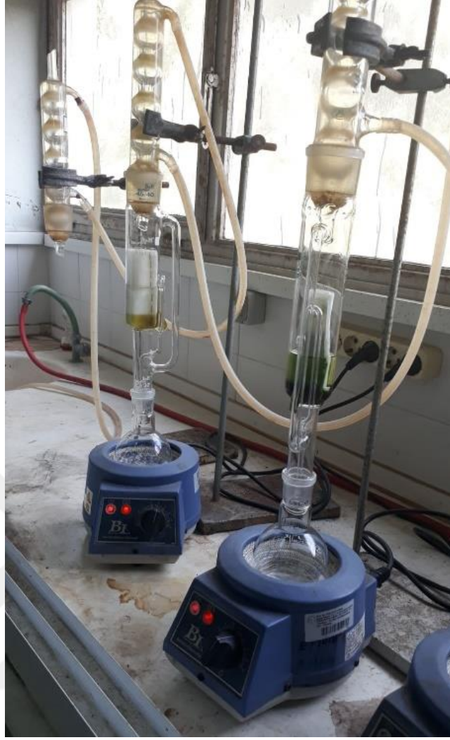
Şekil 4. Soxhlet ekstraktörü ile tohum ve yapraklardan ekstre hazırlanışı
