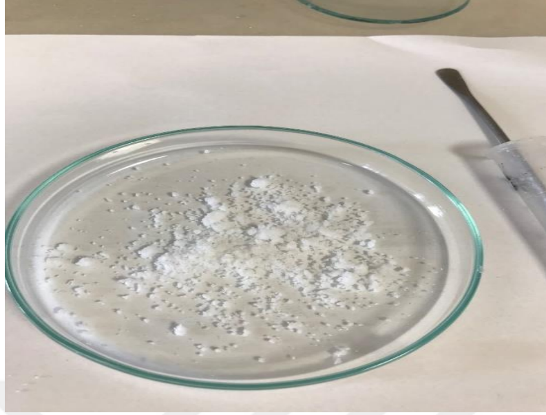
Şekil 3.8. Boş sol-jel enkapsülasyonun kurumuş hali
