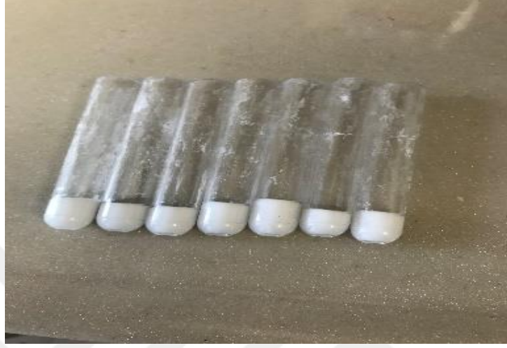
Şekil 3.7. Boş sol-jel enkapsülasyonu
