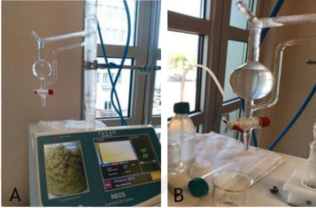
Şekil 3.2. (A) SFME cihazı ve (B) SFME cihazı ile elde edilen PK esansiyel yağı
