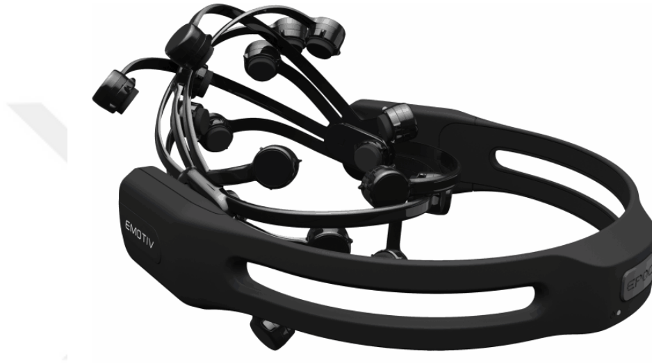
Şekil 3.1. Emotiv Epoc+ cihazı
