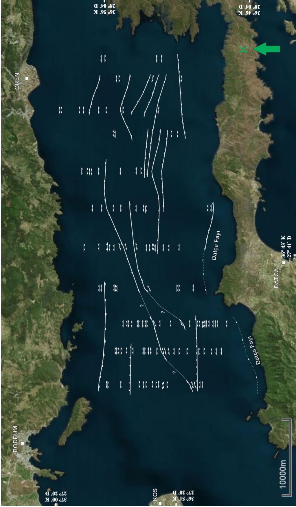
Şekil 4.1. Gökova körfezine ait sismik yansıma kesitlerinin yorumlanmasıyla oluşturulan fay haritası (fayların üzerindeki işaretler eğim yönünü göstermektedir)
