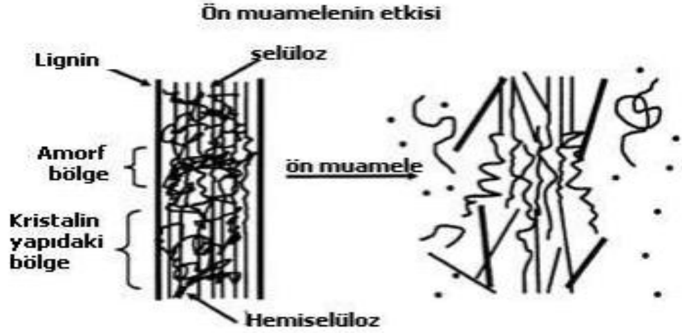
Şekil 2.7 Ön işlemin biyokütle üzerine etkisinin şematik olarak gösterimi (Hsu vd. 1980)
