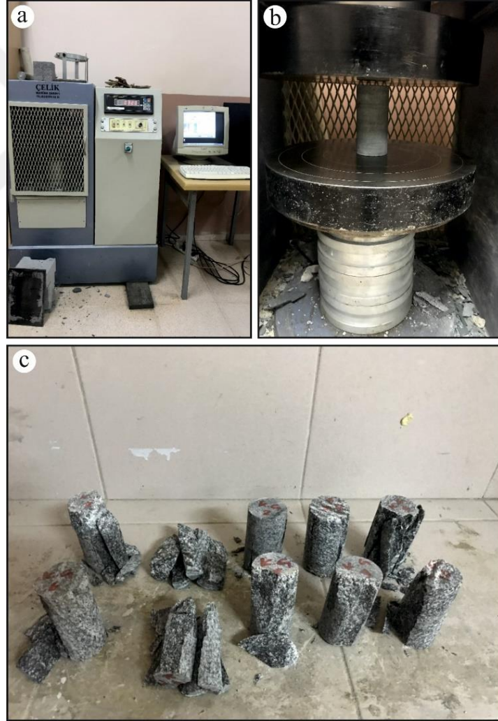
Şekil 3.19. a) Hidrolik pres makinesi b) alt ve üst tabla arasında sıkıştırılan karot numunesi c) karotların kırılma şekilleri
