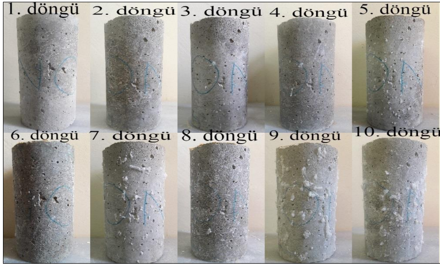
Şekil 3.29. Antifriz katkısız %10 sodyum sülfat içerikli 0°C'de üretilen hafif beton numunesinin değişimi
