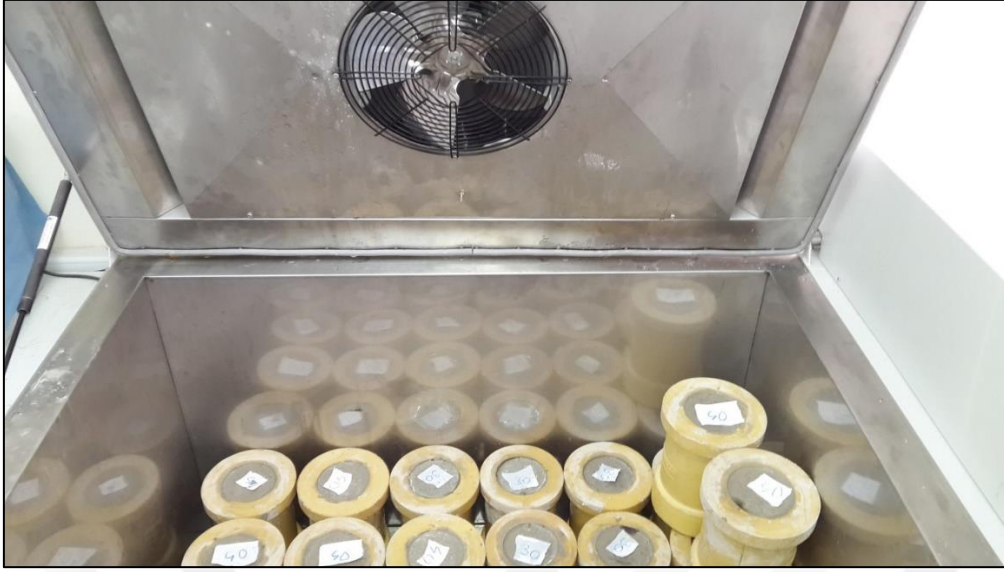
Şekil 2.2. Dona maruz bırakılan beton örnekler
