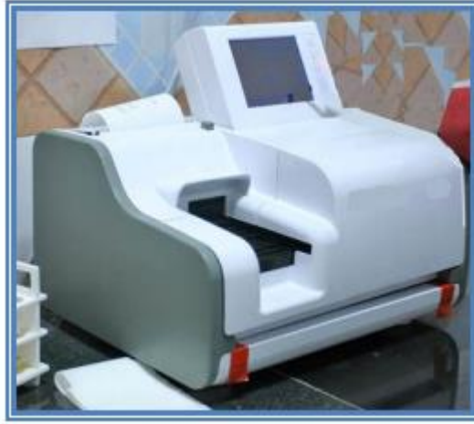
Şekil 2.2. Reflektans fotometre yöntemi ile çalışan strip okuyucu örneği
