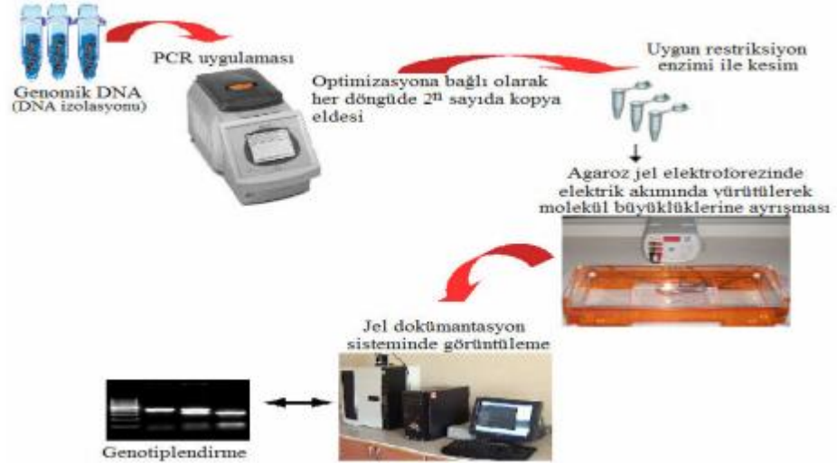
Şekil 2.5. RFLP analiz tekniği aşamaları (Aytekin, 2011)
