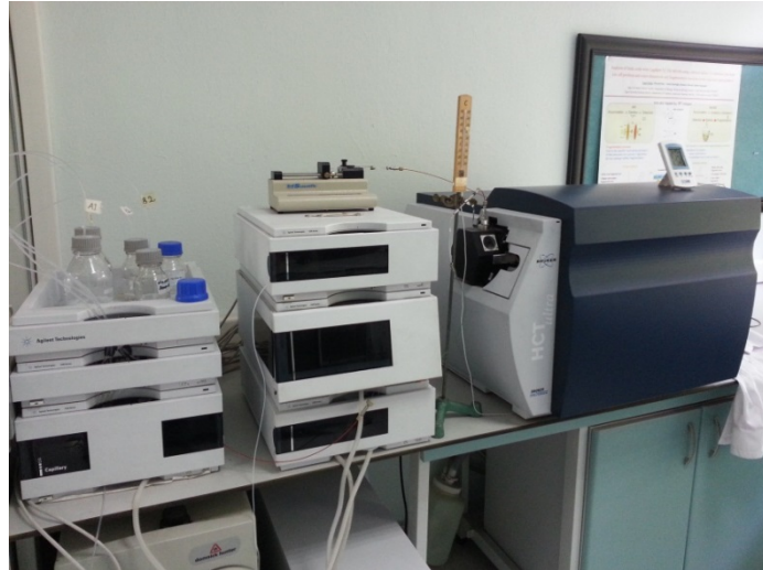
Şekil 3.11: Analizlerin Yapıldığı CapLC-ESI-MS/MS Sistemi (Orig.)
