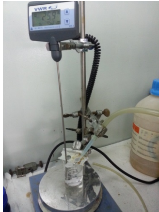
Şekil 3.13: Solüsyonların Azotla Uçurma İşlemlerinin Yapıldığı Düzenek (Orig.)
