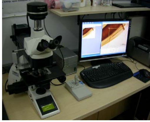
Şekil 3.19: Bilgisayara Bağlı Mikroskop-Kamera-Motorize Stage Sistemi (Orig.)
