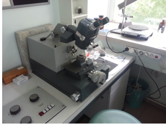
Şekil 3.17: Kesit Alınan Ultramikrotom (Orig.)
