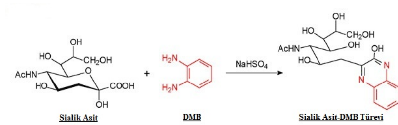
Şekil 3.16: Sialik Asit ve DMB Reaksiyonu (Anonim)
