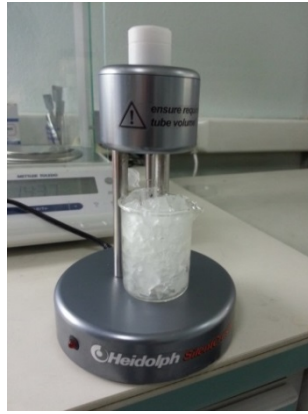
Şekil 3.12: Homojenizasyonun Yapıldığı Homojenizatör (Orig.)
