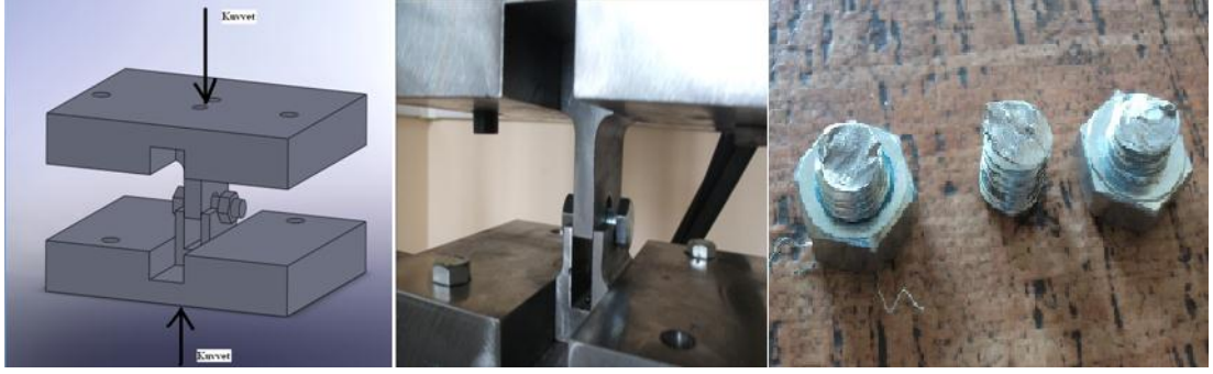
Şekil 6.10: Kesme deneyi aparat tasarımı.
