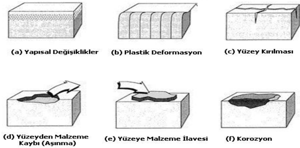
Şekil 1.14. Yüzey hasarlarının sınıflandırılması (Şematik) (ASM, Volume 18)
