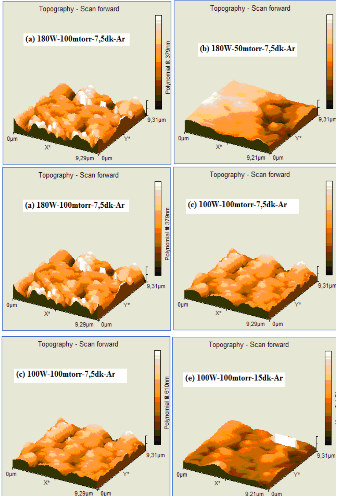
Şekil 4.67. Vakum şartlarında Suda sertleştirme ve 500 °C’de temperlenmiş alt malzeme üzerine plazma ile PTFE kaplanmış numunelerin AFM görüntüleri
