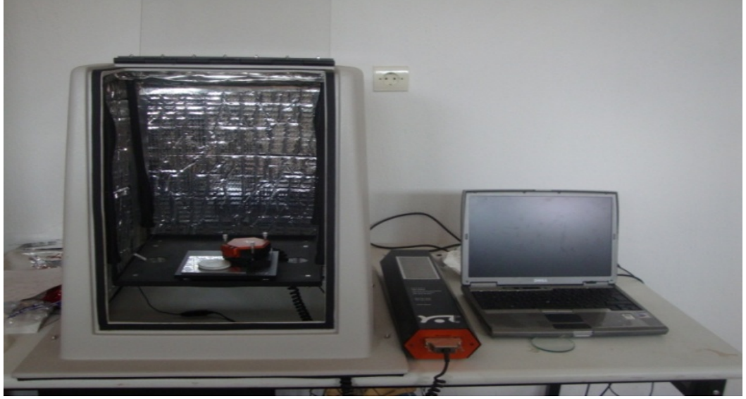
Şekil 3.13. Kaplama yüzey topografisi incelemelerinde kullanılan AFM cihazının genel görünüşü
