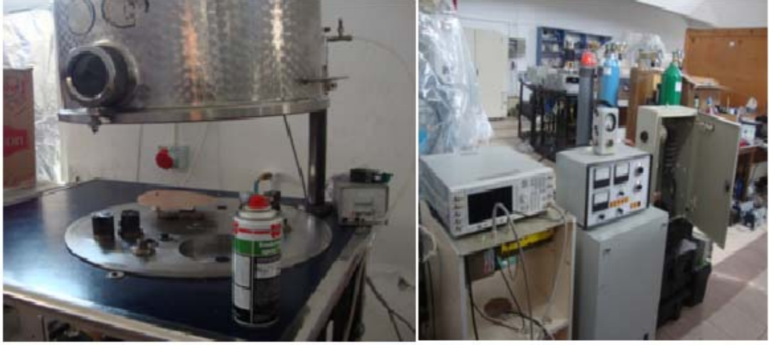
Şekil 3.8. PTFE vakum şartlarında plazma kaplama işlemi deney düzeneğinin işleme hazır halde genel görünüşü
