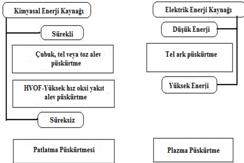
Şekil 1.3.Temel termal püskürtme yöntemlerinin enerji kaynaklarına göre sınıflandırılması (Heimann, 2006)
