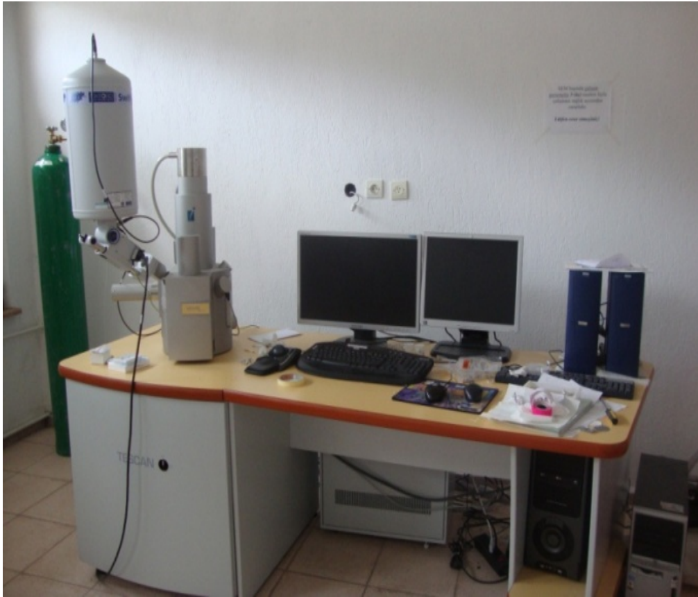
Şekil 3.12. Kaplama incelemelerinde kullanılan Tarama Elektron Mikroskobunun genel görünüşü
