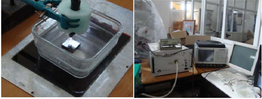
Şekil 3.5. Atmosferik şartlarda plazma kaplama işlemi deney düzeneğinin genel görünüşü
