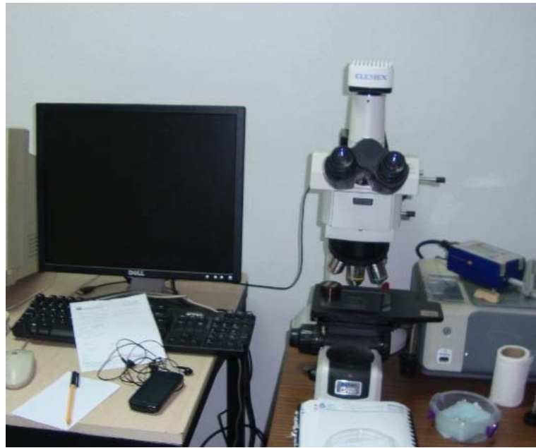
Şekil 3.11. Aşınma izi incelemelerinde kullanılan Optik Mikroskobunun genel görünüşü
