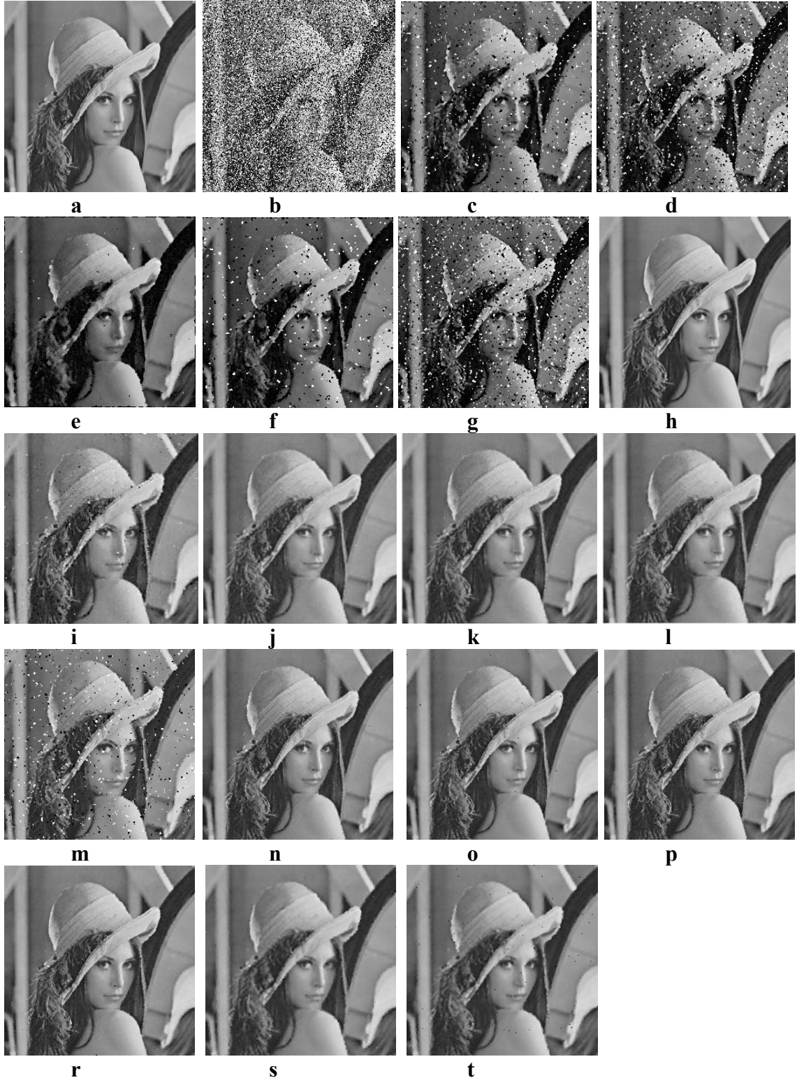
Şekil 4.17. a) Asıl Lena görüntüsü b) %40 tuz ve biber gürültülü görüntü c) OS d) MAOS e) AnOS f) ÜDOS g) ÇDOS (Baştürk ve Yüksel, 2005) h) GAS i) DS (Beşdok ve ark., 2005) j) BS-Kİ k) BS-Dİ l) BS-Kül (Çivicioğlu ve Alçı, 2004) m) ŞOS n) ŞDYOS o) ŞDYOBS p) ŞDYOS5 r) ŞDYOBS5 s) DYOS t) DYOBS kullanılarak elde edilen görüntüler
