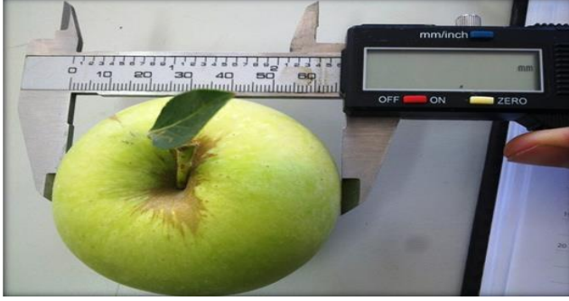
Şekil 20. Dijital kumpas ile meyve eninin ölçümü.
