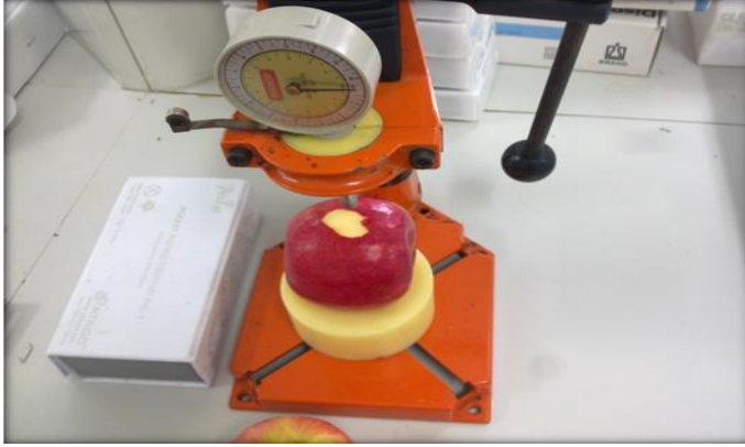
Şekil 22. Penetrometre yardımı ile meyve eti sertliği ölçümü.
