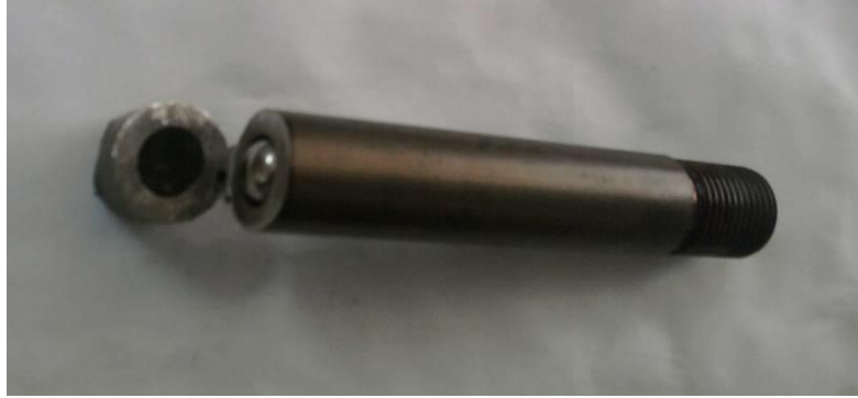
Şekil 3.9: 13 mm Çapındaki Bilyanın Reaktöre Sıkışması
