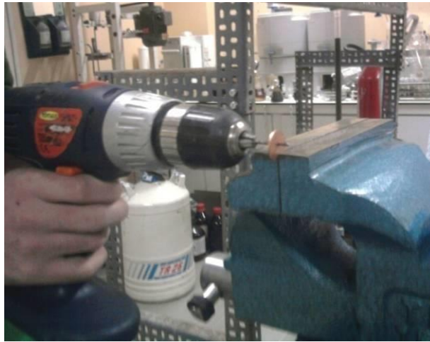
Şekil 3.12 Bakır Contanın Ortasına Elektrikli Maktap İle 1 mm Çapında Delik Açılması
