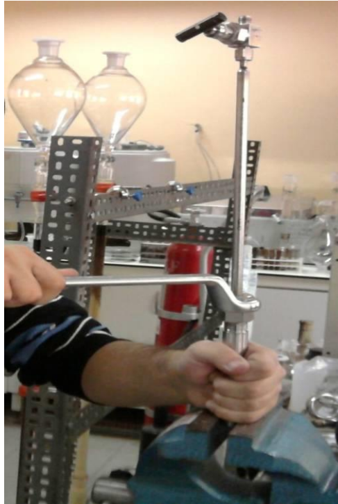
Şekil 3.14: Reaktörün Alt ve Üst Kısımlarının Birleştirilmesi
