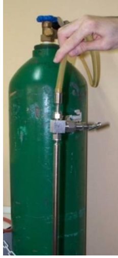
Şekil 3.15: Reaktörün Azot Gazı ile Tart Edilmesi
