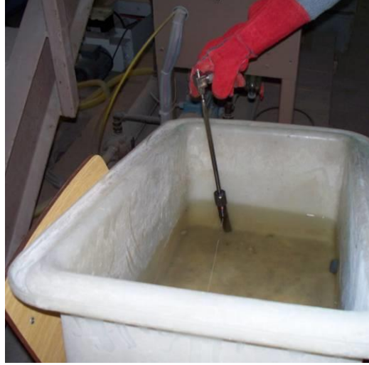
Şekil 3.21: Su Banyosunda Reaksiyonun Durdurulması ve Reaktörün Soğutulması
