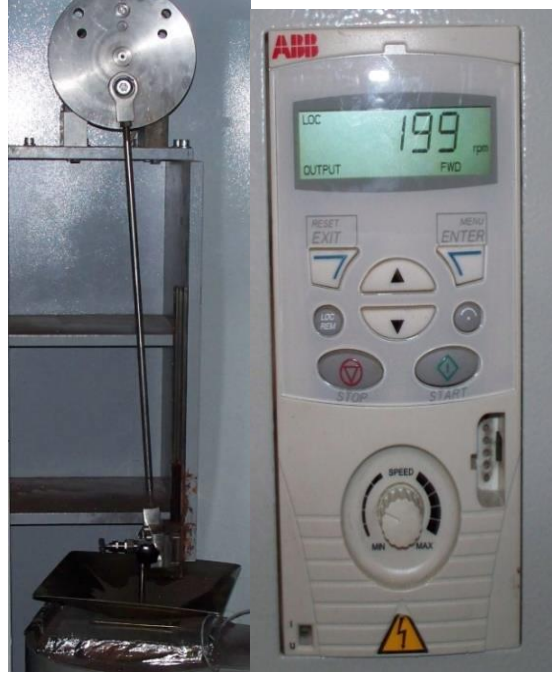
Şekil 3.19: Dikey Karıştırma Düzeneği ve Hız Kontrol Ünitesi
