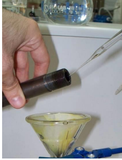
Şekil 3.22: Reaktörün Toluene İle Yıkınması ve Süzgeç Kağıdından Geçirilmesi İşlemi
