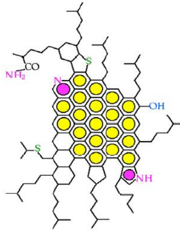
Şekil 2.6 : Carbognani Tarafından Önerilmiş Venezuela Ham Petrolünden Elde Edilmiş 510 °C İçin Asfaltin Molekül Yapısı [17]
