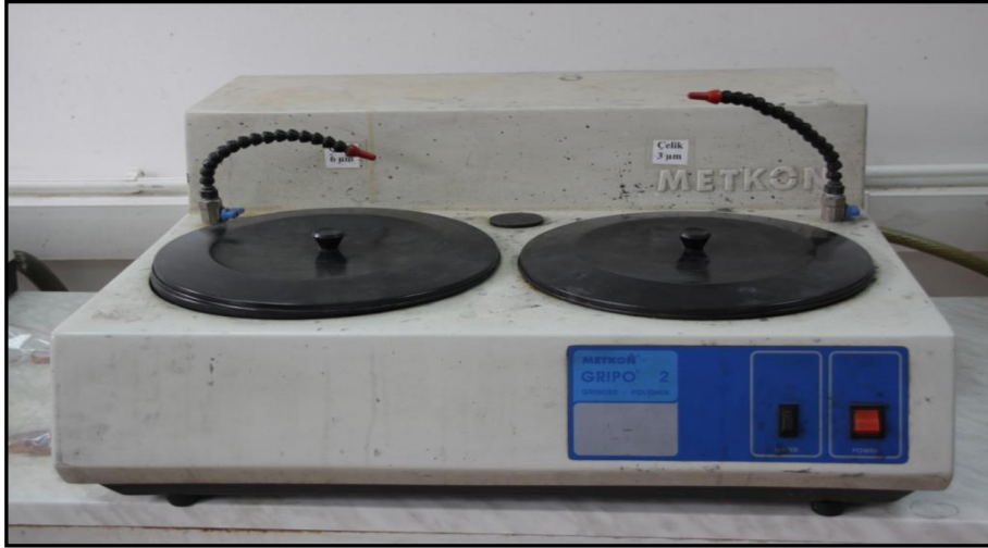
Resim 6.1. Kaynaklı numunelerin parlatmasında Metkon Gripo2 Polisaj cihazı.
