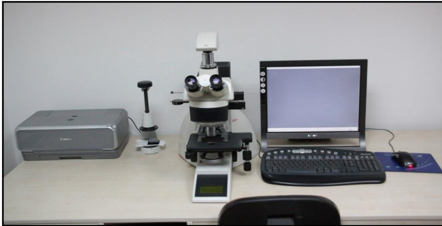
Resim 6.2. Mikroyapıların görüntülenmesinde Leica DFC 320 dijital kamera bağlantılı Leica DM 4000 M model optik mikroskop.
