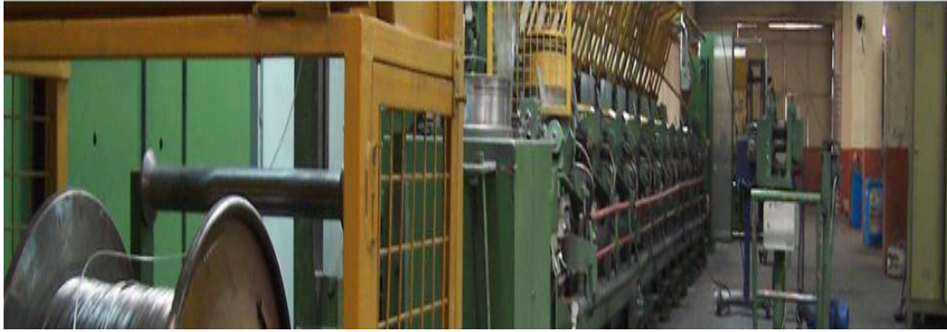
Resim 5.1. Elektrod kaynak öz­lü tel üretim hattı.
