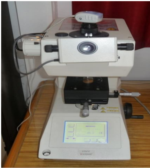
Resim 6.3. Mikro sertlik cihazı Shimadzu HMV2 mikro sertlik cihazı.
