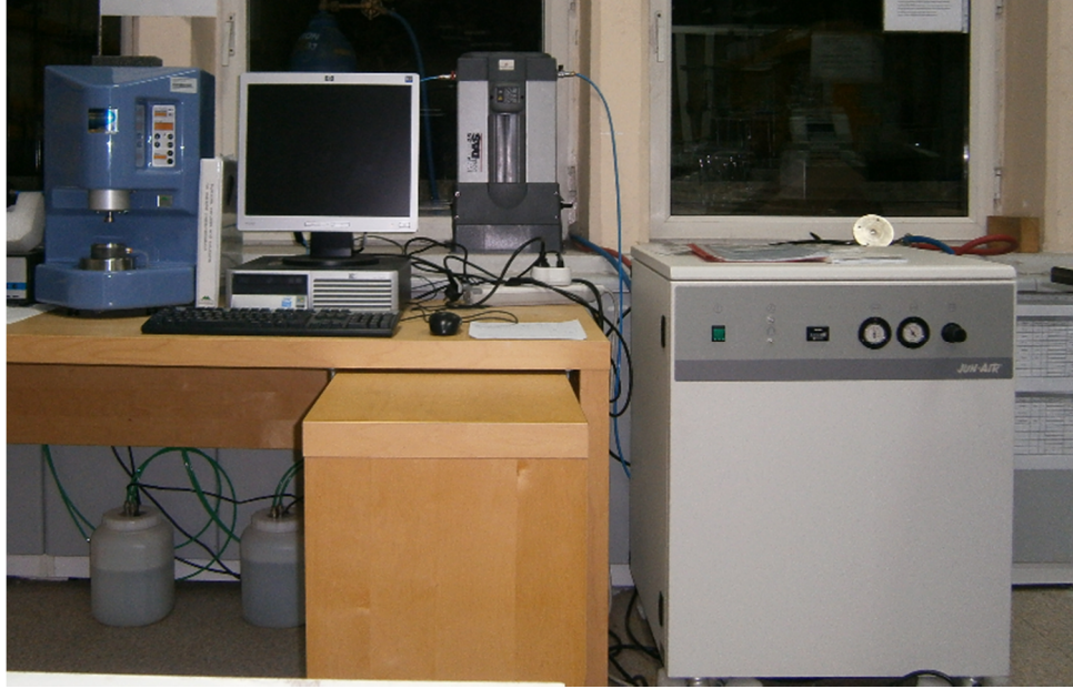
Şekil 3.3 : Reometre cihazı (solda), PC ekranı (ortada) ve kompresör (sağda).
