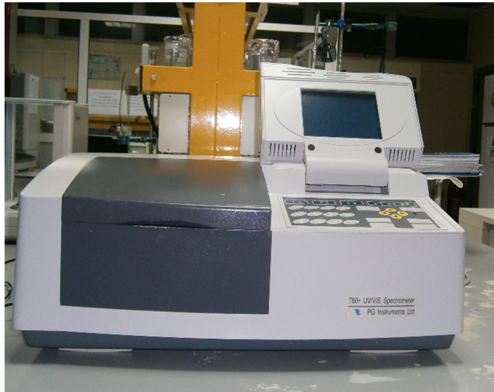
Şekil 3.4 : T80 UV-görünür spektrofotometre cihazı.
