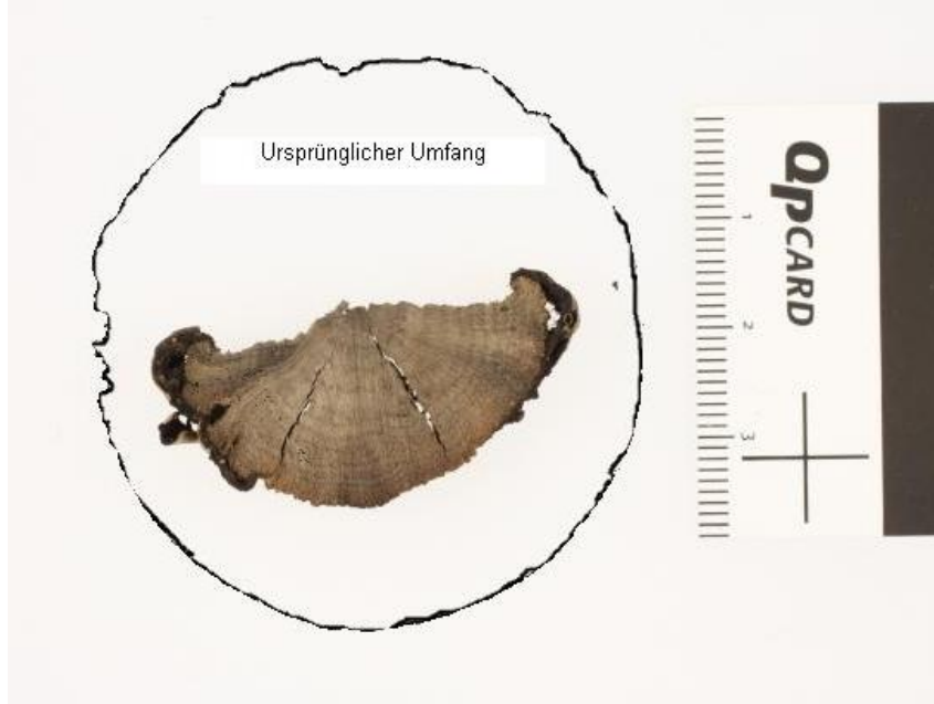
Fotoğraf 2: Emdirme olmadan gerçekleştirilen kurutma sonrası suya doymuş ahşapta meydana gelen deformasyon. (W. Muskalla)
