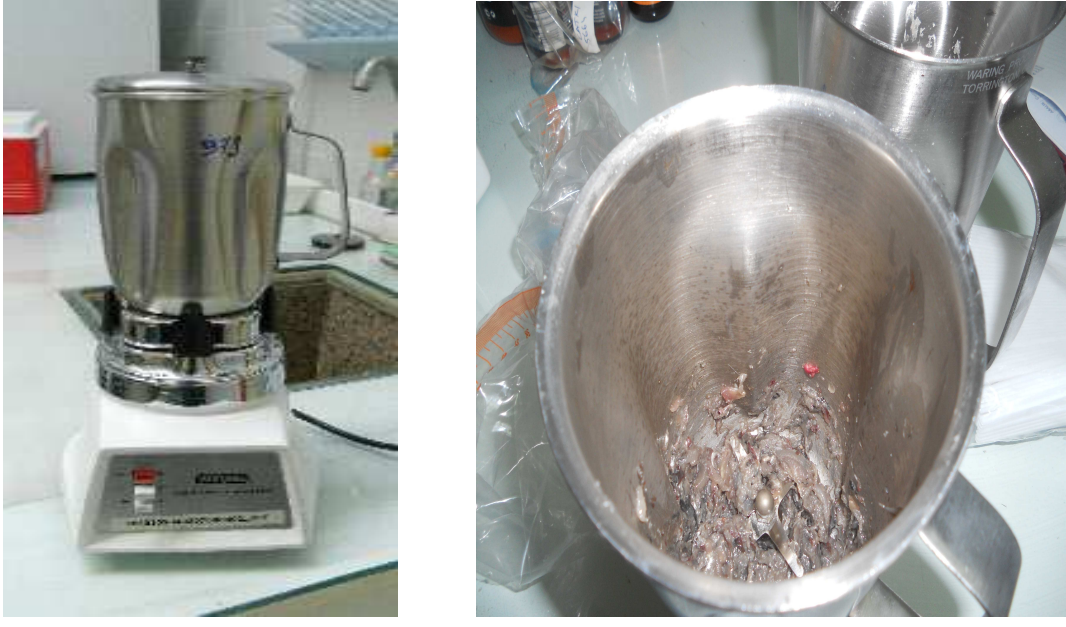
Şekil 3.1. Waring marka çelik blender ile homojenize işlemi
