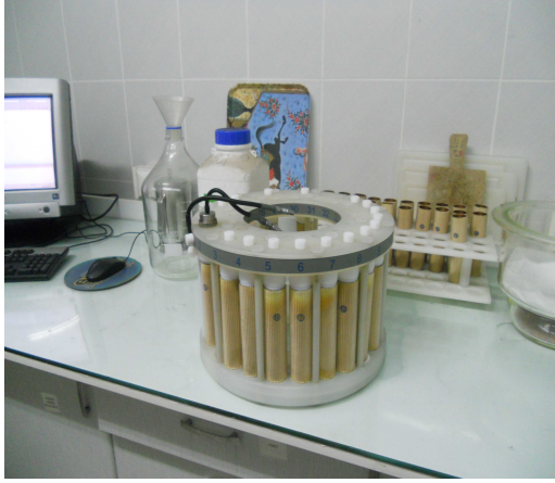
Şekil 3.3. Mikro dalga fırında çözünürleştirme işlemi
