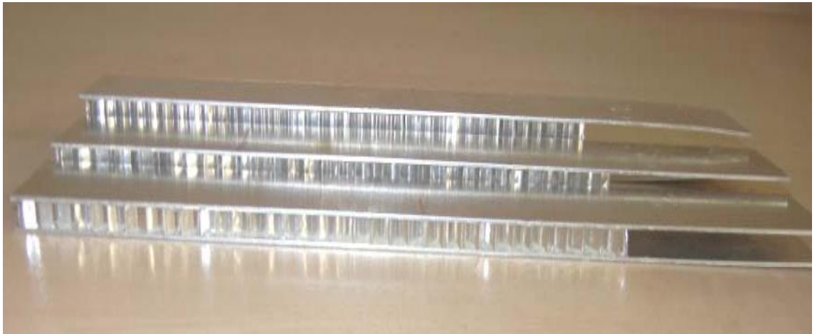
Şekil 3.3. Deneylerde kullanılmak üzere üretilen bal peteği sandviç numuneler
