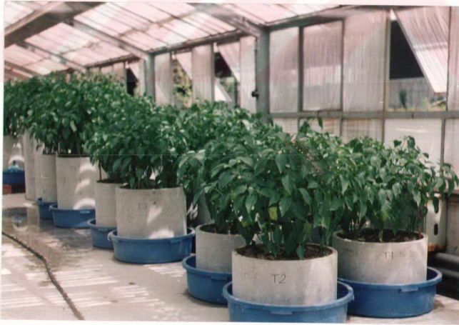
Şekil 3.1. Lizimetre olarak kullanılan deneme kolonları
