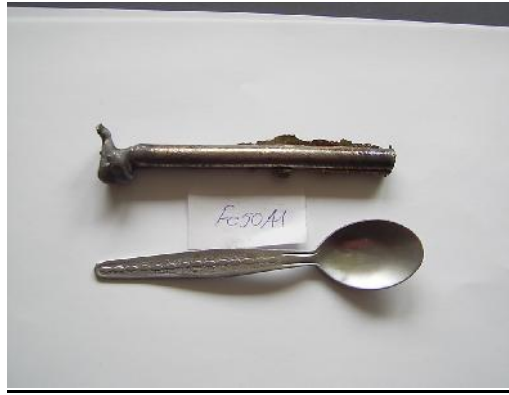
ekin 3.1 Ark ergitme ile üretilen Fe50Al ala ımı.
