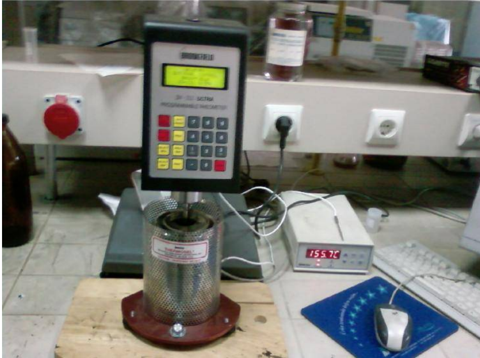
Resim 5.2. Brookfield DV III Ultra Marka programlanabilir viskozimetre
