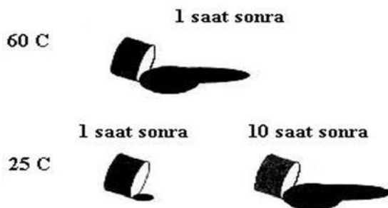
Şekil 2.7. Asfaltın zaman ve sıcaklığa göre davranışı [26]
