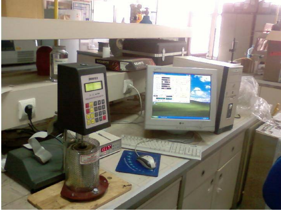
Resim 5.1. Brookfield DV III Ultra Marka programlanabilir viskozimetre
