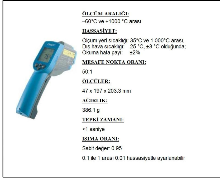
Şekil 4.17 Işınım termometresi özellikleri
