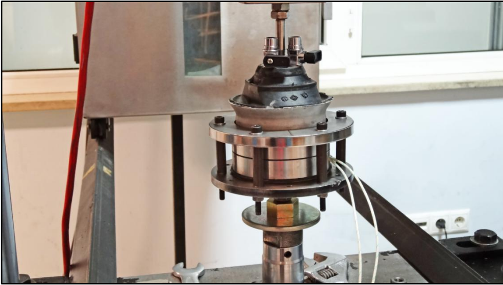
Resim 3.6. MR takozun MTS Test Cihazına bağlanması
