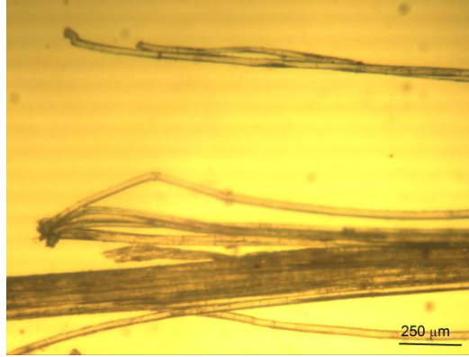
Şekil 1.11. Keten elyafın optik mikroskop görüntüsü
