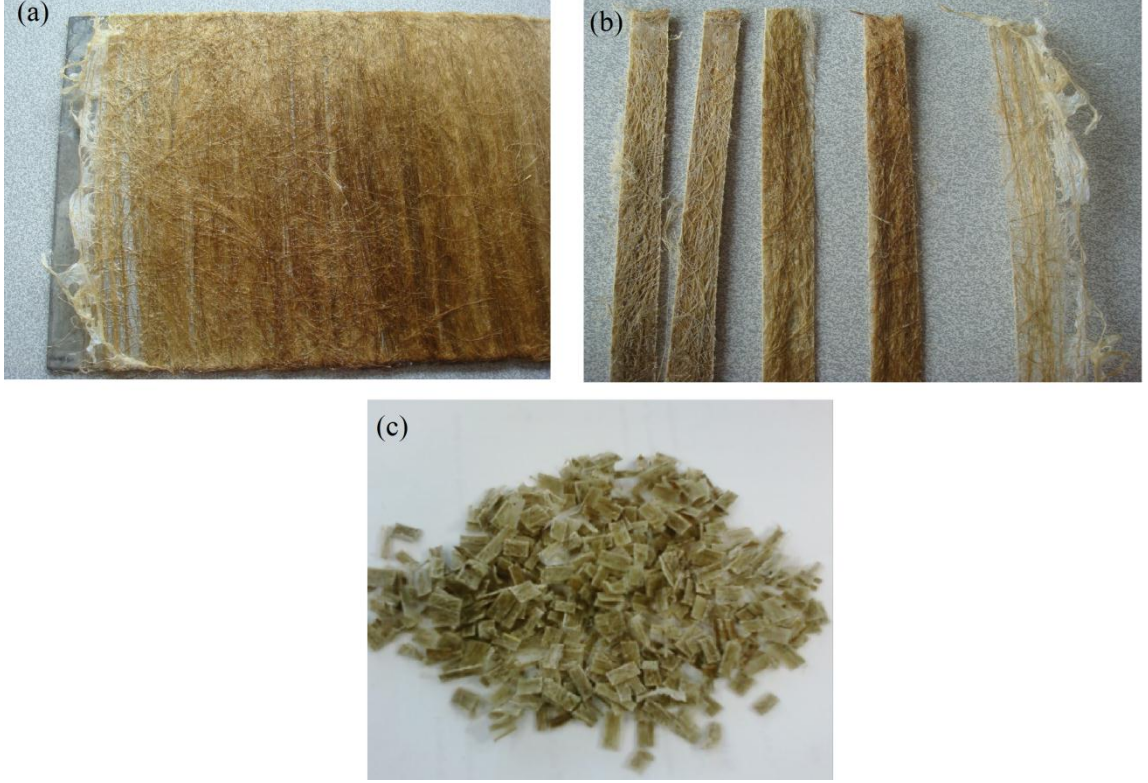
Şekil 3.3. a)PLA kaplanan keten plakası, b) PLA kaplanan plakanın şerit halinde kesimi, c) 0,5 cm uzunluğunda kırılmış PLA kaplı keten
