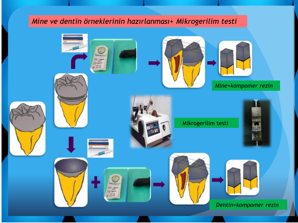
Şekil.3.16. Mine ve dentin-kompomer rezin çubuklarının elde edilişi ve mikrogerilim testi şematik görünümü.
