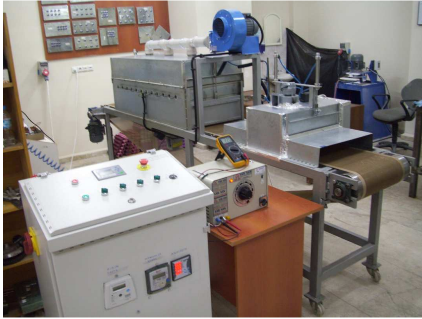
Şekil 3.1: MW-fan destekli konveksiyon ısıtma sistemi.
