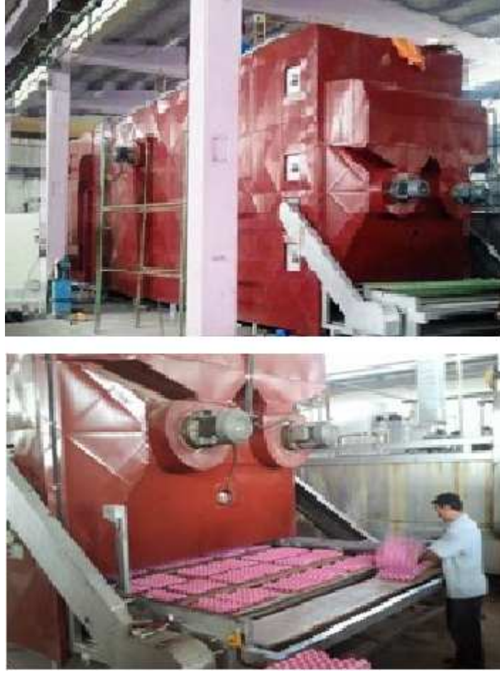
Şekil 2.1 : Sanayi ortamındaki yumurta kolisi kurutma sistemi.
