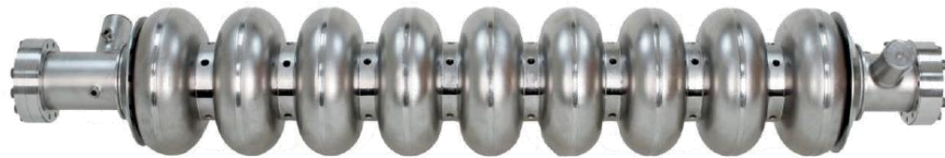
Şekil 4.4. 9 hücreli süper iletken Nb kavite (Linearcollider, 2012)
