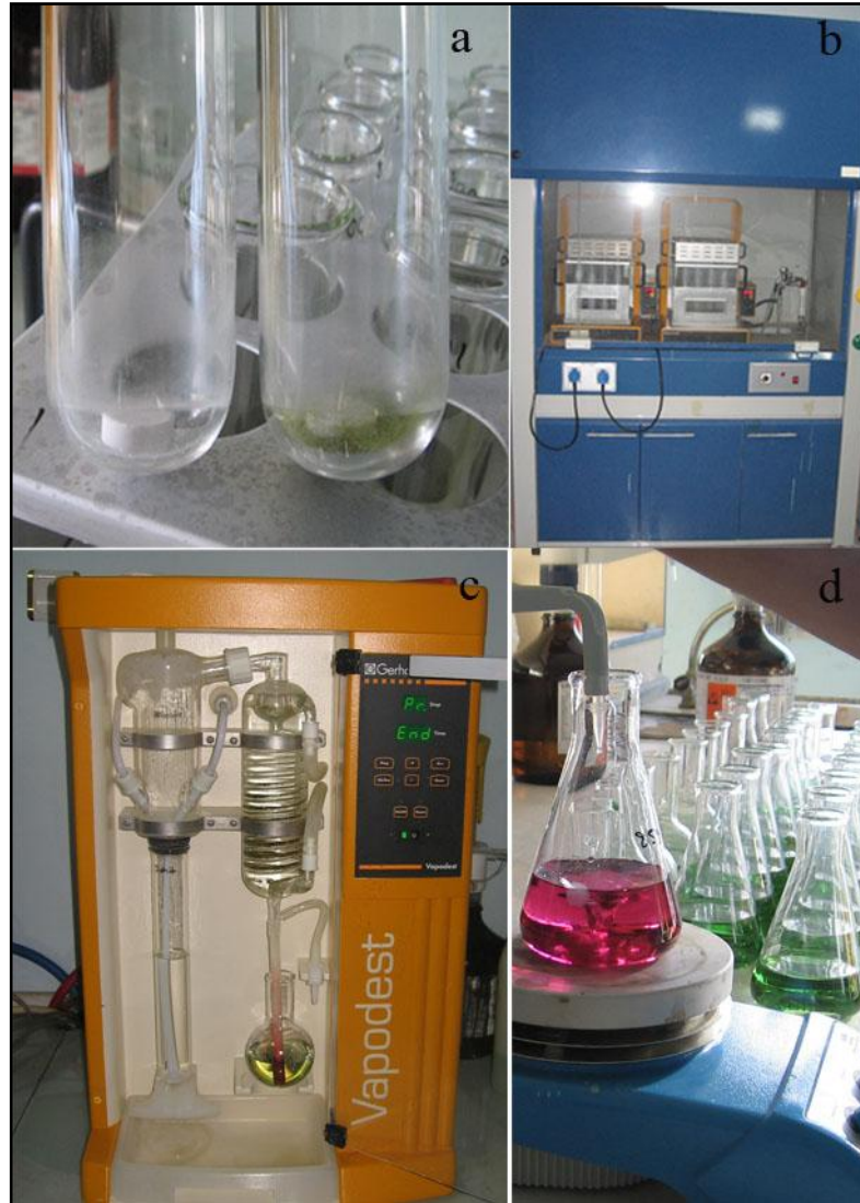
Şekil 3.16. Kjeldahl yaş yakma metodunun farklı aşamaları. a) Şahit (kör) tüpü ve içinde örnek bulunan bir tüp, b) Kjeldahl yakma ünitesi, c) Kjeldahl destilasyon ünitesi, 4) Titrasyon aşaması (orjinal)
