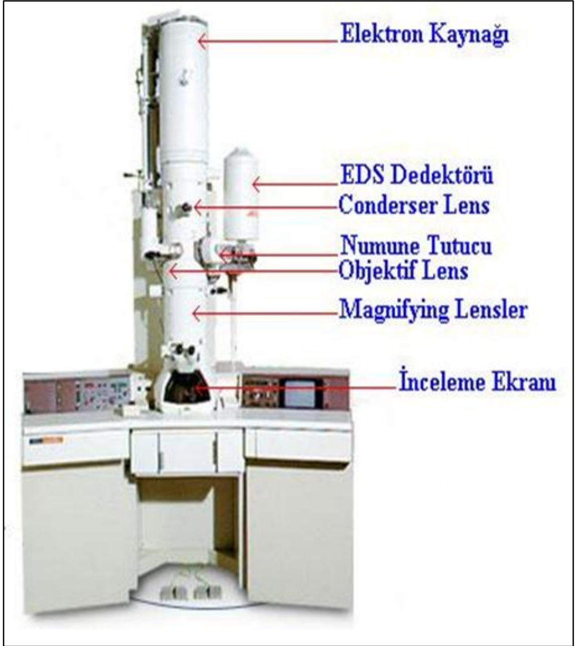
Şekil 2.14. JEOL 300 keV TEM in genel yapısı (Kırıkkale Üniversitesi Araştırma Merkezi)
