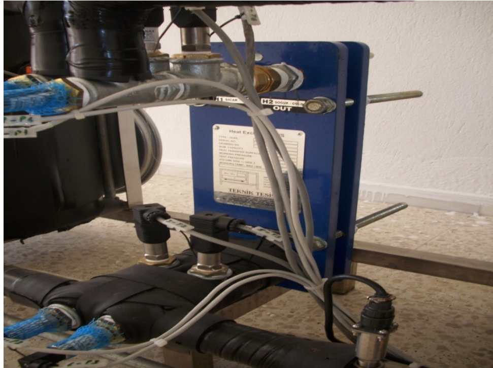
Şekil A.4. Plakalı ısı eşanjörü (karşı-yan görünüş)
