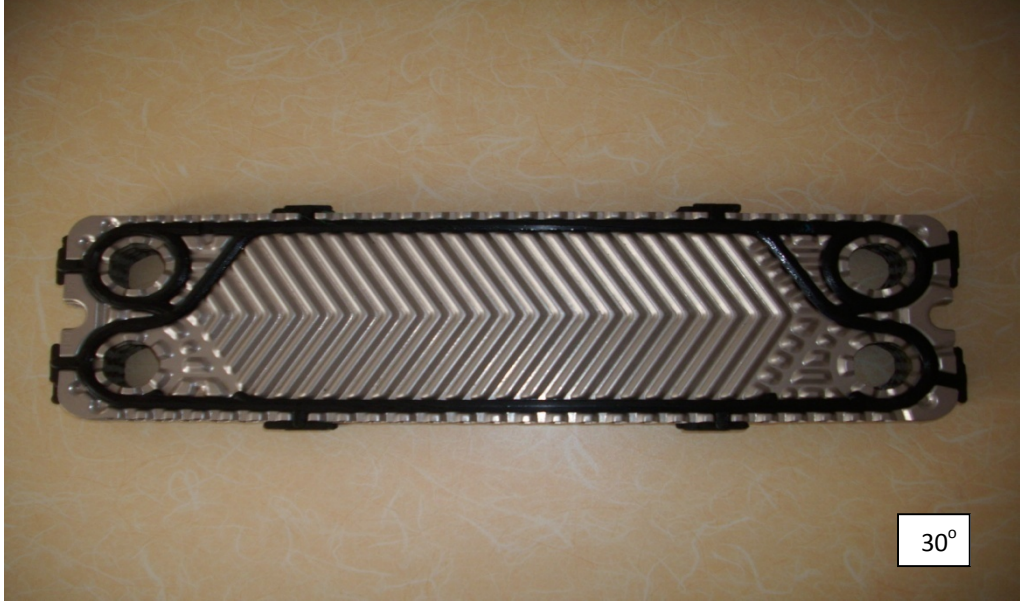
Şekil A.1. 30° açılı plakalı ısı eşanjörü
