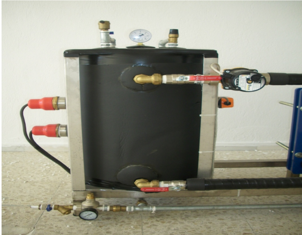
Şekil A.8. Sıcak su üretici kazanı (yandan görünüş)
