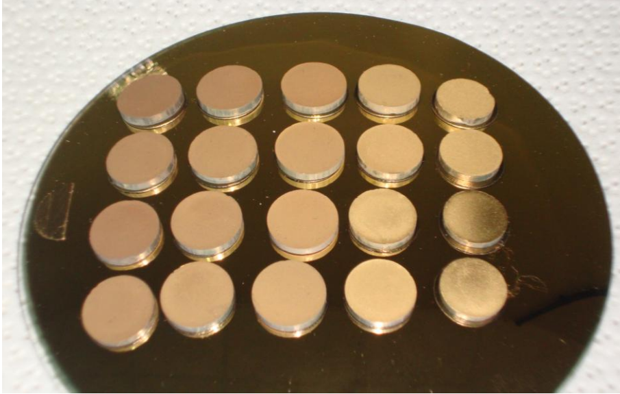
Şekil 3.11 : Tarama elektron mikroskopisi için Au Kaplanmış Ag-HA numuneleri
