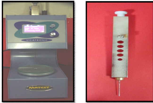
Resim 2.7. Otomatik Vicat Cihazı ve Vicat iğnesi
