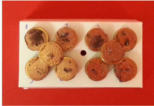
Resim 2.17. Deney gruplarının altın film ile kaplanmış görüntüsü
