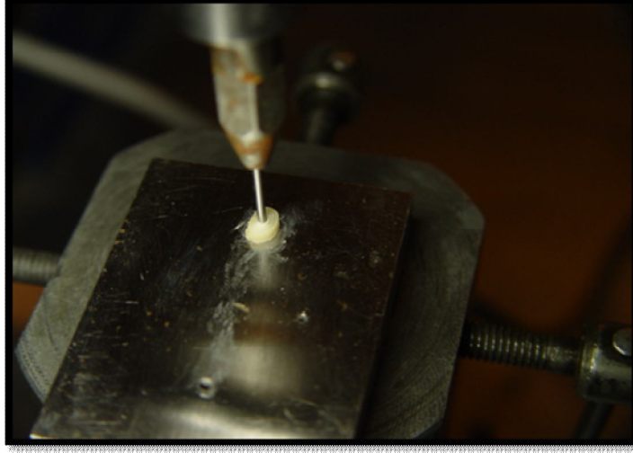
Resim 2.13. Push-out bağlanma dayanımı test düzeneği
