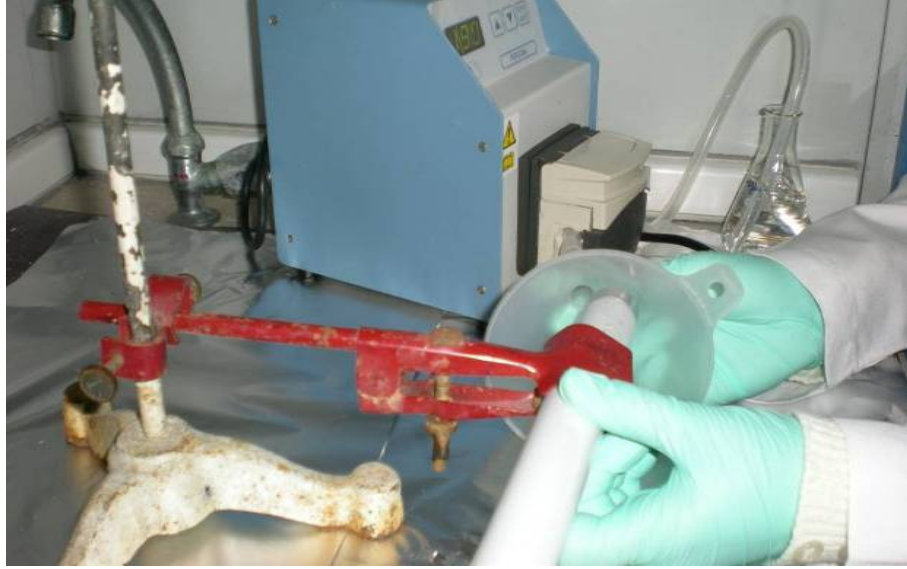
Şekil 3.5. Floresan lamba buhar faz toplama sistemi
