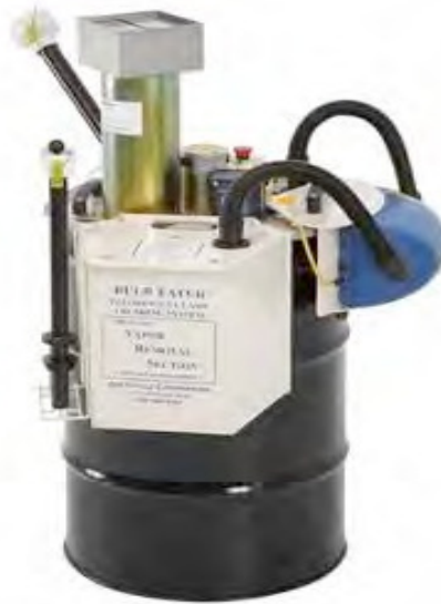
Şekil 2.8. BulbEater® floresan imha sistemi (ARC Danışmanlık, 2010)
