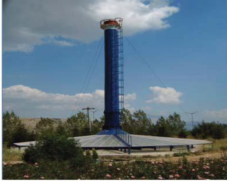
Şekil 1.5. Süleyman Demirel Üniversitesi Güneş Bacası Çalışması(Koyun, 2006)
