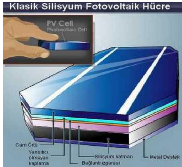
Şekil 3.11. Foto voltaik pilin yapısı ve katmanları
