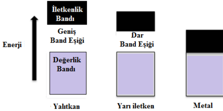
Şekil 1.5 : Metal, Yarı-İletken, Yalıtkan maddelerde enerji seviyeleri.
