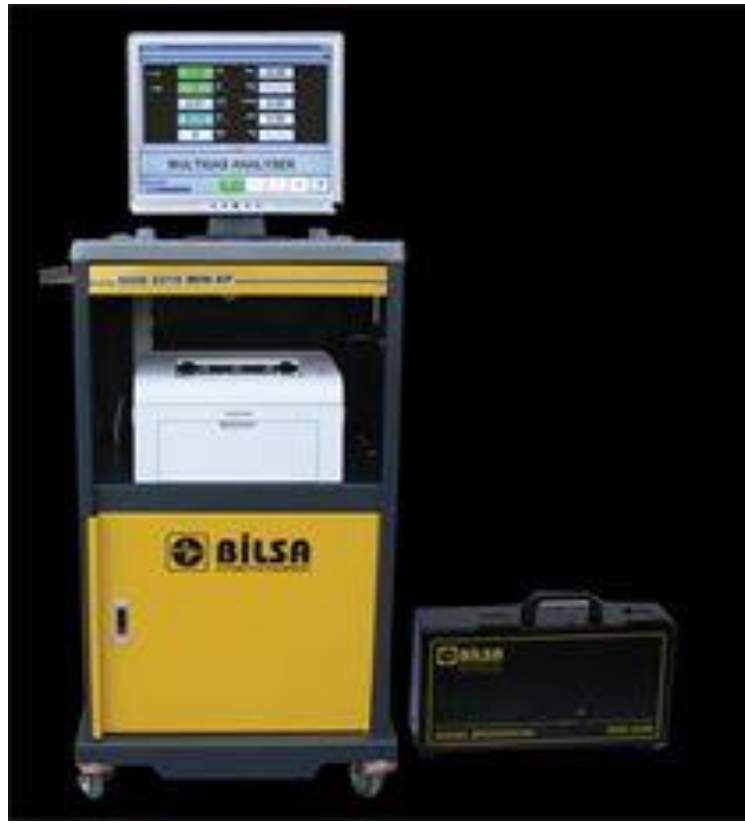
Şekil 2.6. Egzoz gaz analiz ölçüm cihazı
