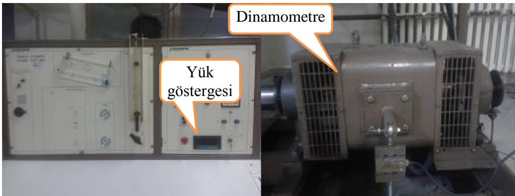
Şekil 2.4. Motor Dinamometresi ve yük kontrol sistemi
