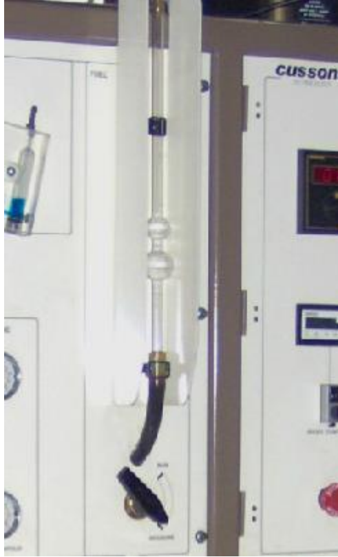
Şekil 2.5. Yakıt tüketim ölçüm sistemi
