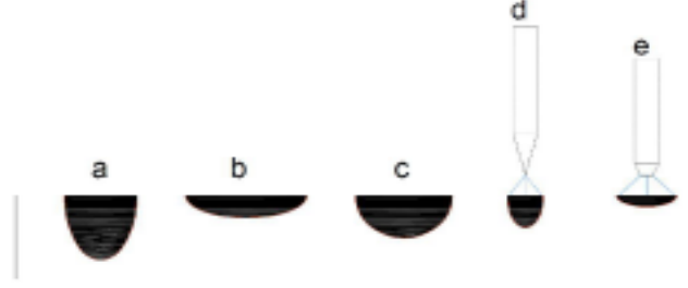
Şekil 1.7. Akım türü, kutup türü ve elektrot formuna bağlı olarak nüfuziyet formları [9]
