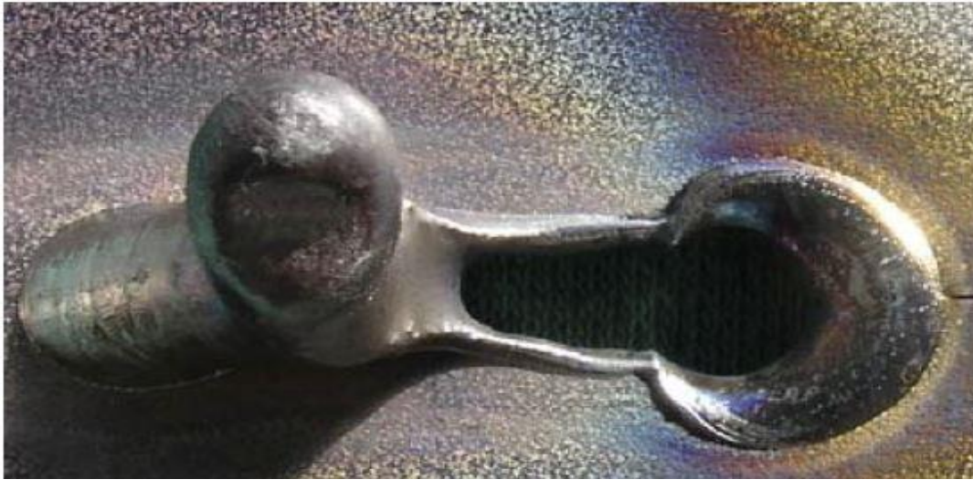
Şekil 1.17. A-TIG kaynağında kök delinmesi [25]
