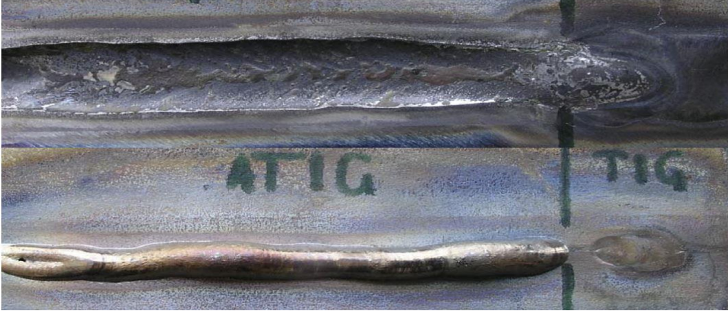
Şekil 1.16. A-TIG ve TIG kaynaklarının ön ve arka yüzleri [25]
