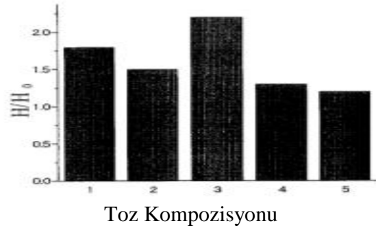
Şekil 1.39. A-TIG kaynağında toz cinsinin nüfuziyete etkisi [26]
