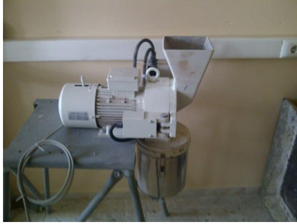
Şekil 3.6. Pomzayı öğütmek için kullanılan FRITSCH Mill öğütme cihazı
