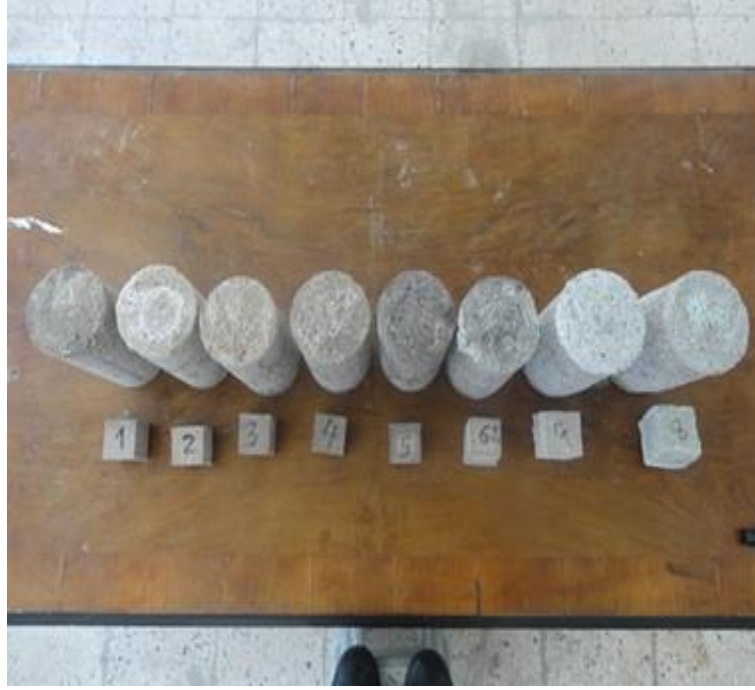
Şekil 4.92. Üretilen beton numunelerinin ve hamurların yüksek sıcaklıklara maruz kaldıktan sonra üstten görünüşü
