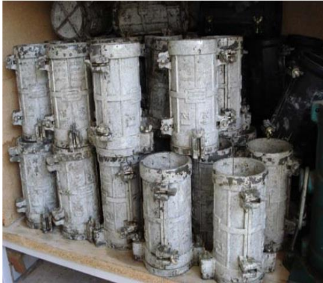
Şekil 3.10. Beton deneylerinde 100 x 200 mm boyutlarında plastik malzemeden yapılmış portatif silindir beton kalıpları
