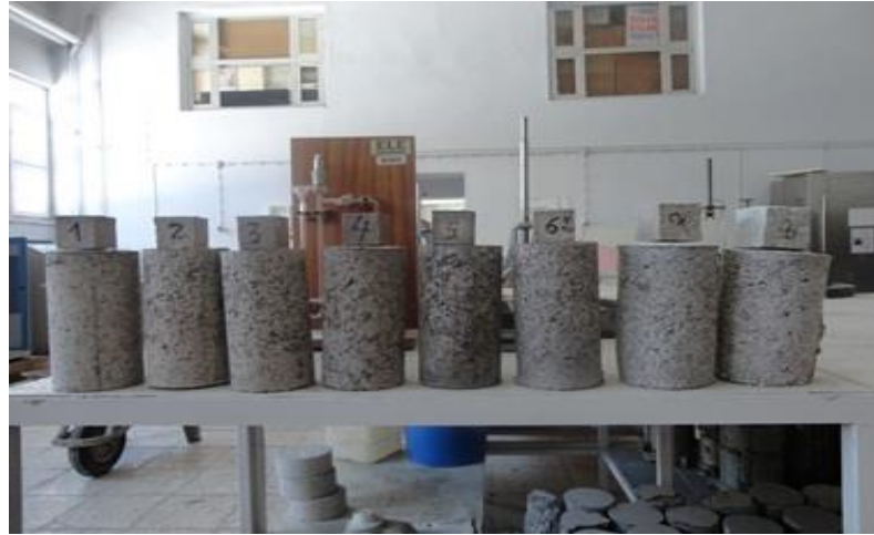
Şekil 4.91. Üretilen beton numunelerinin ve hamurların yüksek sıcaklıklara maruz kaldıktan sonra yan görünüşü
