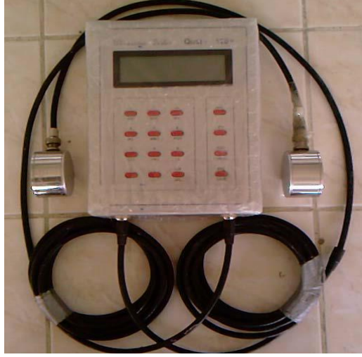
Şekil 3.7. Ultra ses hızı ölçüm cihazı
