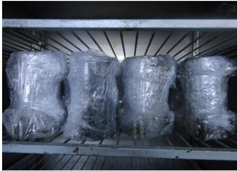
Şekil 4.89. Geopolimer betonların 48 saat fırında kür edilmesi
