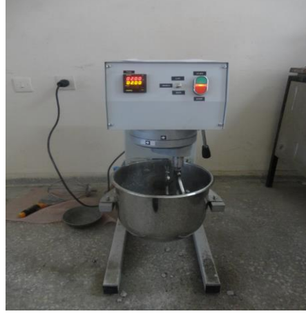
Şekil 3.14. Geopolimer üretiminde kullanılan laboratuvar tipi karıştırıcı
