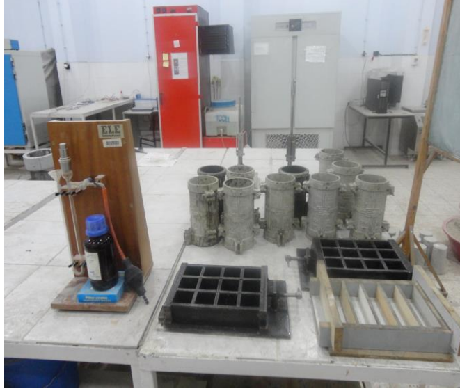
Şekil 3.9. Beton ve hamur numunelerinde kullanılan kalıplar
