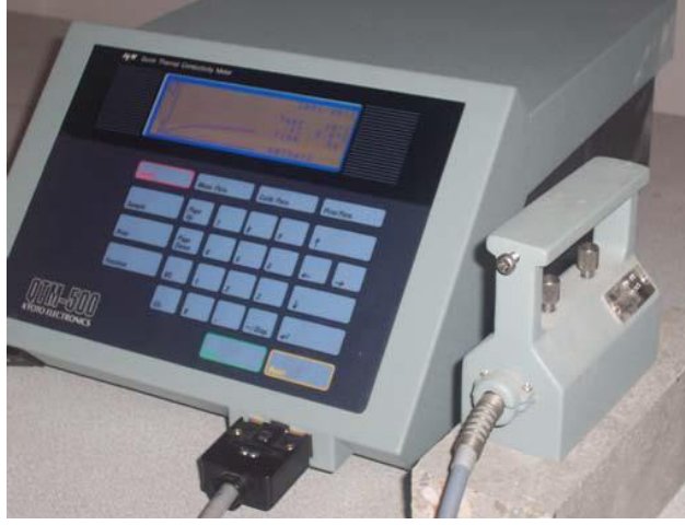
Şekil 3.2. Isı iletkenlik katsayısı ölçüm cihazı
