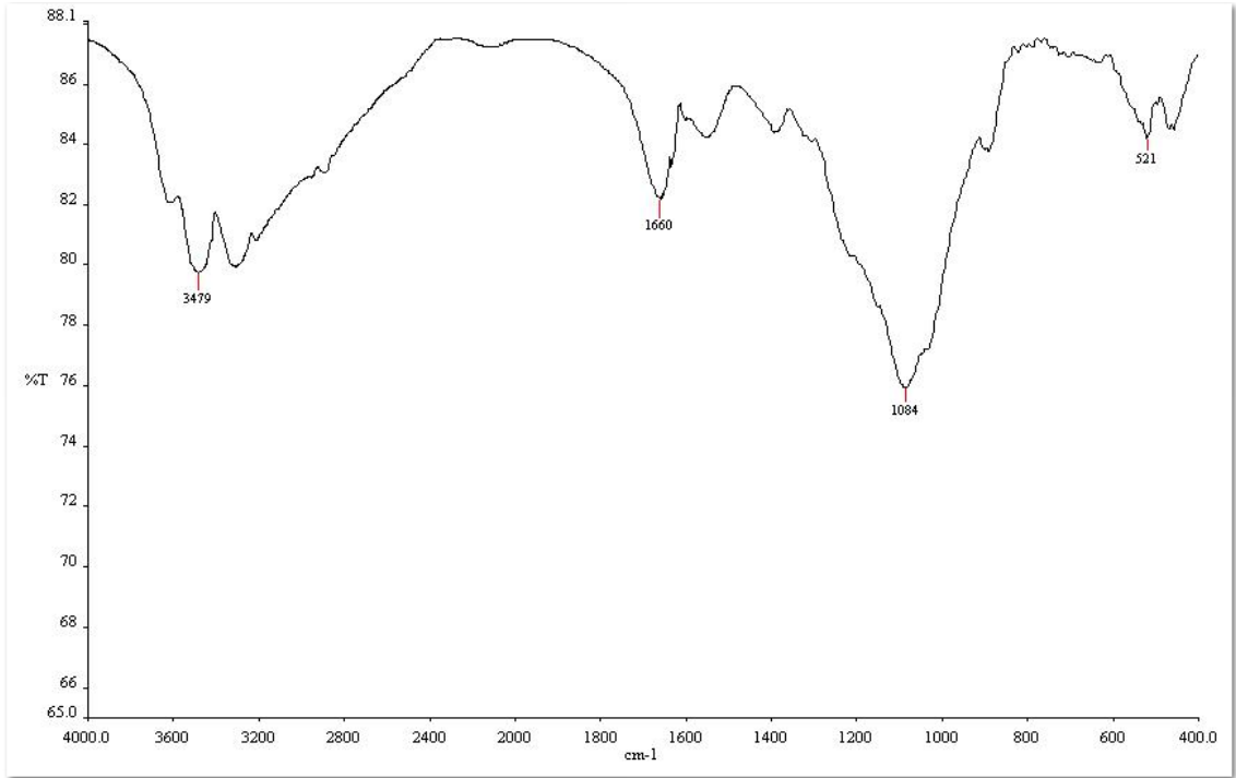
Şekil 3.20: Kitosan-kil kompozit boncukların FTIR analizi
