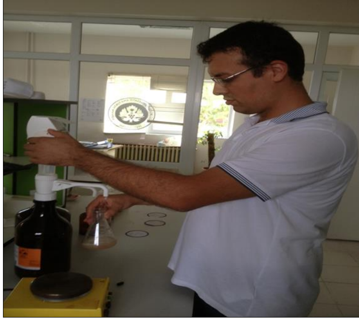
Şekil 4.4. Dijital Brüt İle Tartarik Asit Ölçümü
