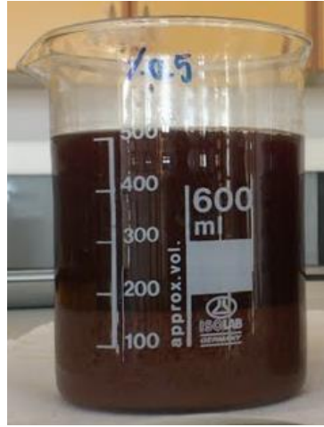
Şekil 4.19 %0,5 koagülant dozaj miktarı koagülasyon/flokülasyon deneyi fotoğrafı
