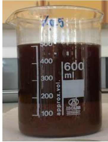
Şekil 4. 25 Anyonik PE Polikim Liba M10115 koagülasyon/flokülasyon deneyi fotoğrafı
