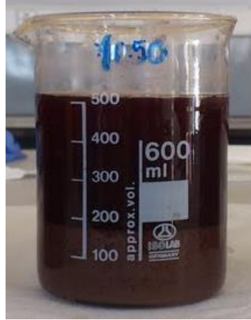
Şekil 4. 26 Katyonik PE 1050 koagülasyon/flokülasyon deneyi fotoğrafı
