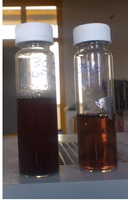
Şekil 4. 40 UF besleme suyu (solda),UF süzüntü suyu (sağda)
