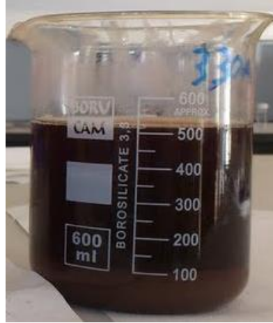
Şekil 4. 24 Yüksek anyonik PE Enfloc 330-A koagülasyon/flokülasyon deneyi fotoğrafı
