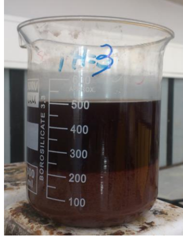
Şekil 4. 21 %1 koagülant dozaj miktarı, koagülasyon/flokülasyon deneyi fotoğrafı
