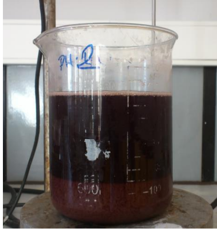
Şekil 4. 10 Optimum pH tayini, pH=2 koagülasyon/flokülasyon deneyi fotoğrafı
