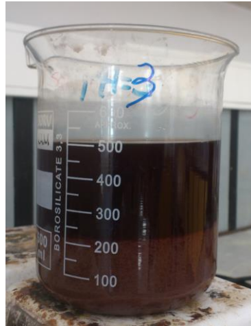
Şekil 4. 11 Optimum pH tayini, pH=3 koagülasyon/flokülasyon deneyi fotoğrafı
