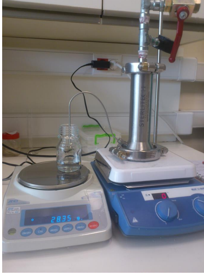
Şekil 3. 7 Laboratuvar ölçekli ölü uçlu membran filtrasyon sistemi
