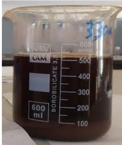
Şekil 4. 33 %0,4 flokülant dozaj miktarı koagülasyon/flokülasyon deneyi fotoğrafı
