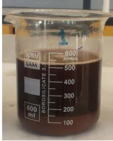
Şekil 4. 31 %0,2 flokülant dozaj miktarı koagülasyon/flokülasyon deneyi fotoğrafı
